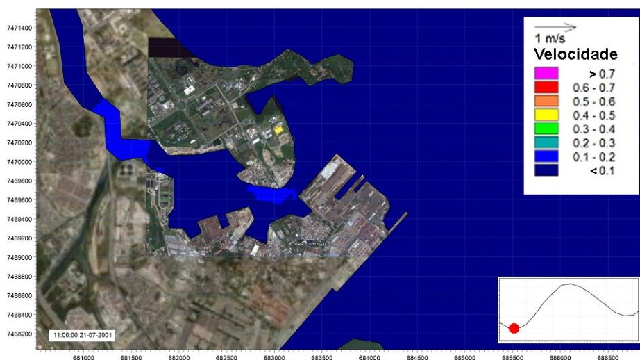
Figura 3.6a Campo de corrente simulado na maré baixa – Situação depois da dragagem.
