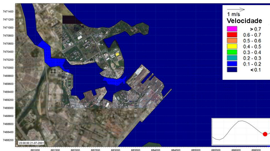
Figura 3.6e: Campo de corrente simulado na maré baixa – Situação depois da dragagem.
