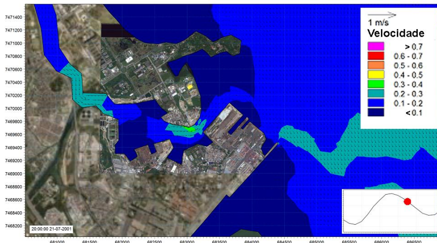
Figure 3.6d: Campo de corrente simulado na maré vazante – Situação depois da dragagem.
