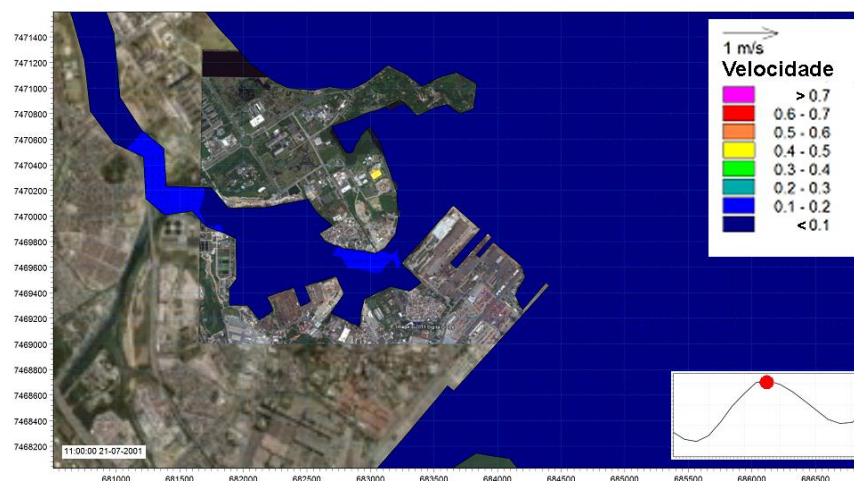
Figure 3.6c: Campo de corrente simulado na maré alta – Situação depois da dragagem.
